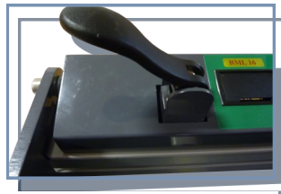
Levier de serrage: verrouillage rapide
